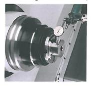
Forkardt garantiert eine Genauigkeit im Bereich von 0,0004" (0,010 mm) TIR für die Spannzangensystemmodelle A und D sowie 0,0008" (0,020 mm) TIR für Modell DL.
